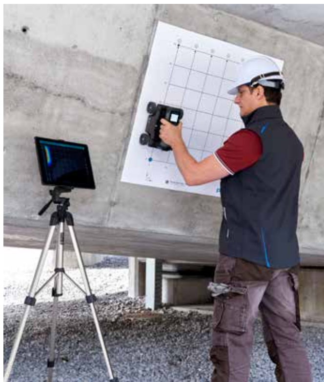
Proceq GPR Live ejecutando una exploración de área con la ayuda del papel cuadrulado de Proceq
